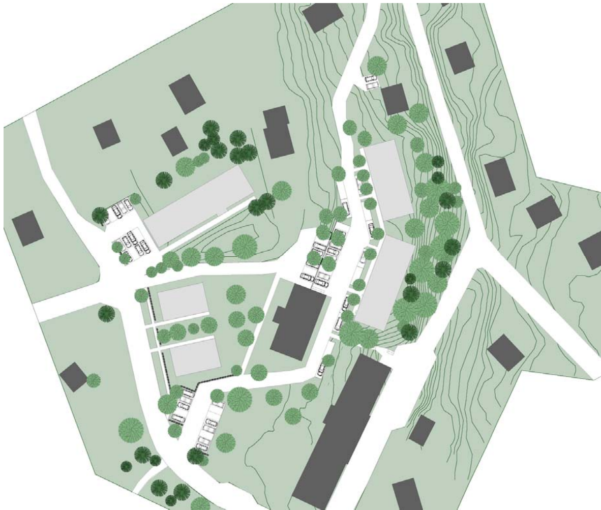
Bild 10. Illustration över föreslagen exploatering där ljusgrå byggnader är tillkommande och mörkgrå befintliga.
